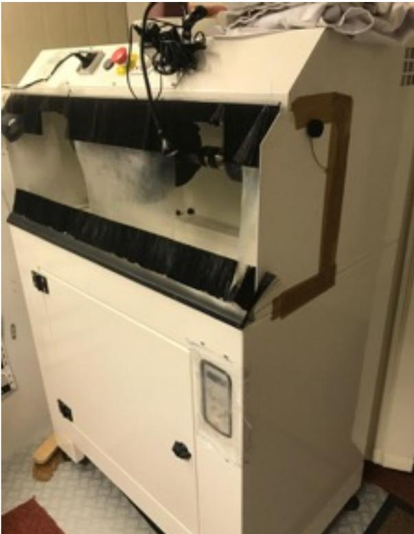
Image 18 : Banc de façonnage avec touret et aspiration
